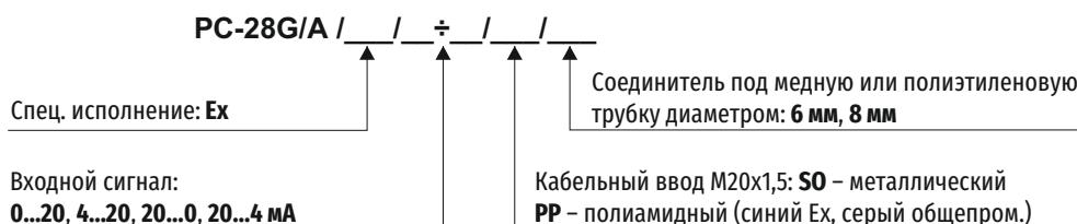
**Пример:** Преобразователь PC-28G/A, искробезопасное исполнение, вход 4...20 mA, металлический кабельный ввод, пневматическое подключение трубкой Ø8
