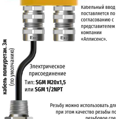
Резьбу можно использовать для монтажа защитного армирования кабеля при этом качество резьбы позволяет создавать огнепроницаемое резьбовое соединение с арматурой Exd.
