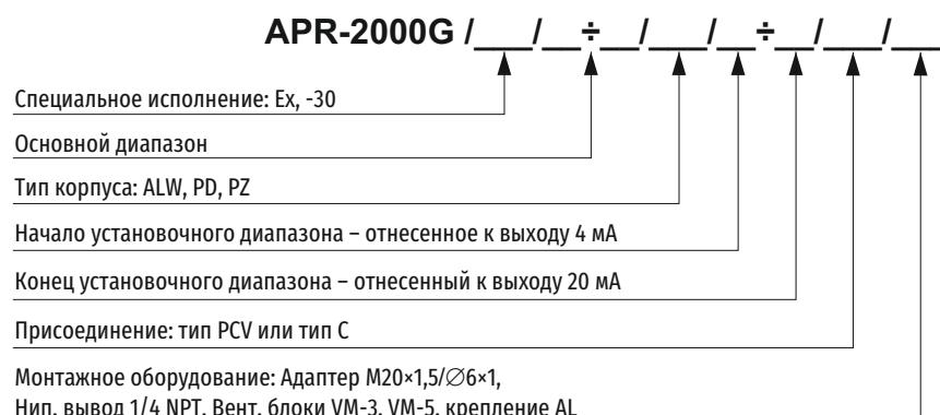
**Пример 1:** Датчик APR-2000G / основной диапазон -700...700 Па / распределительная коробка с зажимами / установочный диапазон -50...100 Па / присоединение типа PCV. Дополнительно адаптер M20x1,5/Ø6x1 – две штуки.
