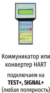
Коммуникатор или конвертер HART подключаем на **TEST+, SIGNAL+** (любая полярность)
