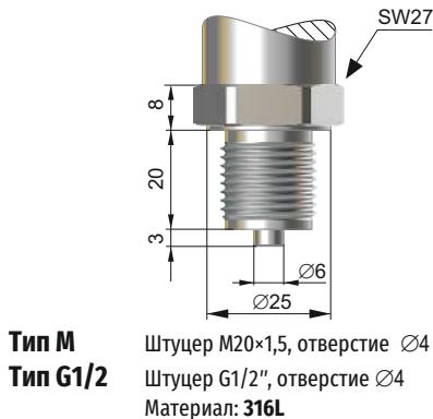
**Тип Р** Штуцер M20×1,5, отверстие Ø12
